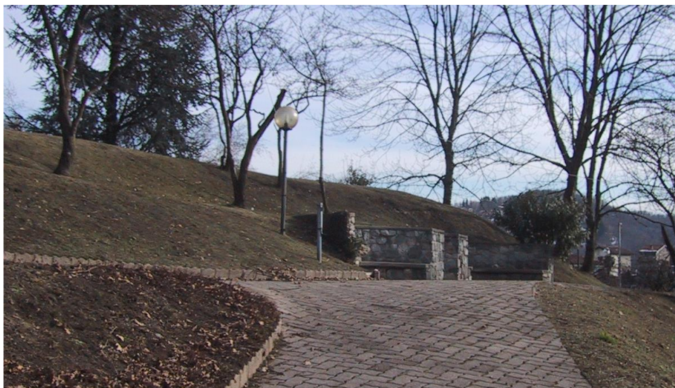
Area pubblica di Brezzo - percezione diurna e notturna: apparecchi decorativi tipo globo diffondente non conformi alla normativa vigente. E' evidente dalla percezione fotografica notturna la dispersione del flusso luminoso verso la volta celeste
